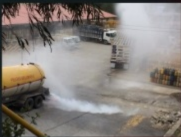
Fuga de GLP en un Autotanque
