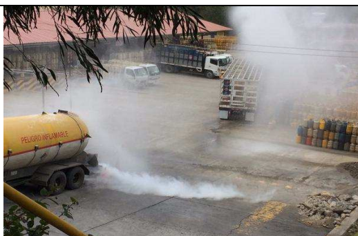
Fuga de GLP en un Autotanque
